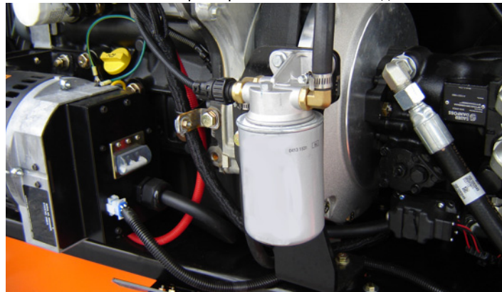
С. Топливный фильтр — Deutz TD 2,9 (на двигателе)
