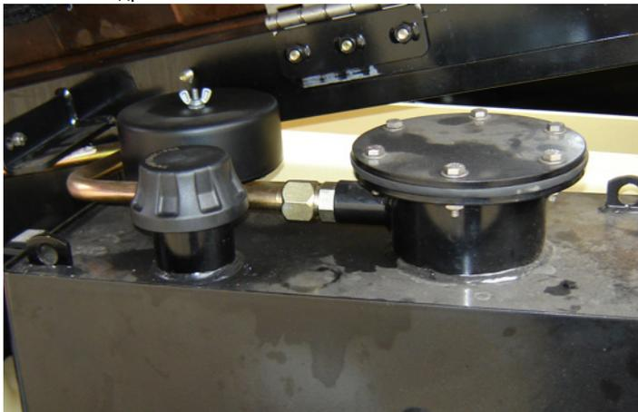
Точки смазки — заливная крышка
