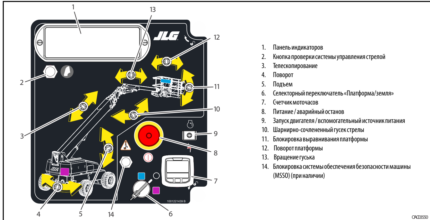
Рис. 3-2. Пульт управления с земли машин с MSSO
