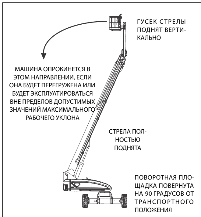
Рис. 4-2. Положение минимальной устойчивости против опрокидывания назад
