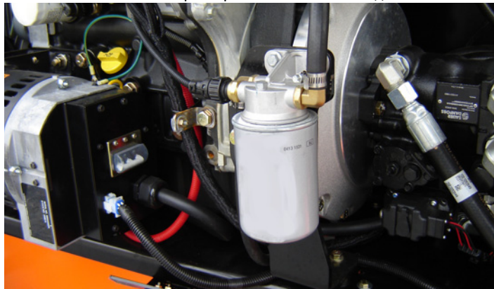
С. Топливный фильтр — Deutz TD 2,9 (на двигателе)
