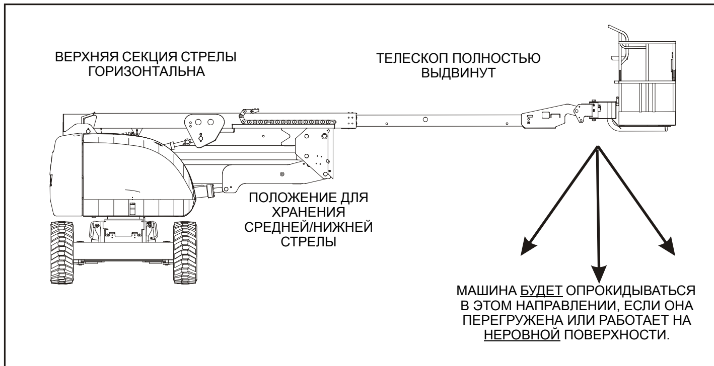
Рис. 4-1. Положение минимальной устойчивости против опрокидывания вперед
