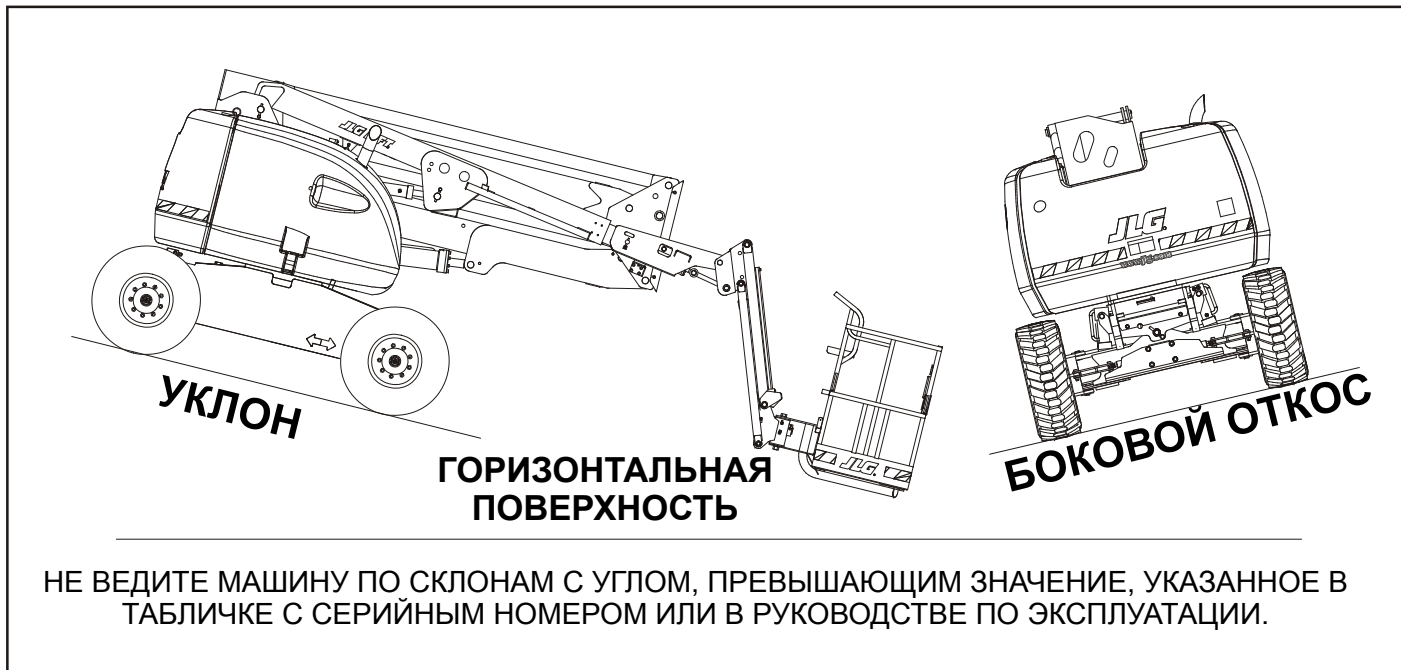
Рис. 4-3. Уклон и боковые откосы
